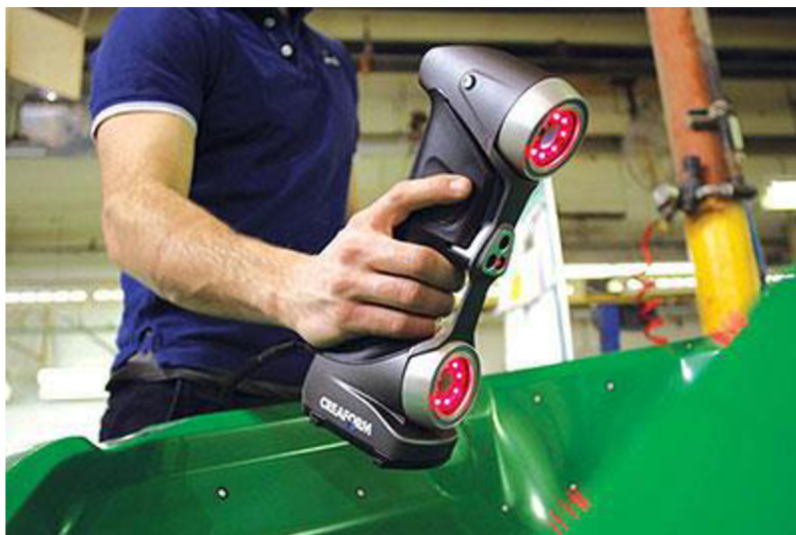
Obr. 3.14 Ruční laserový 3D skener HandyScan 3D [47]
