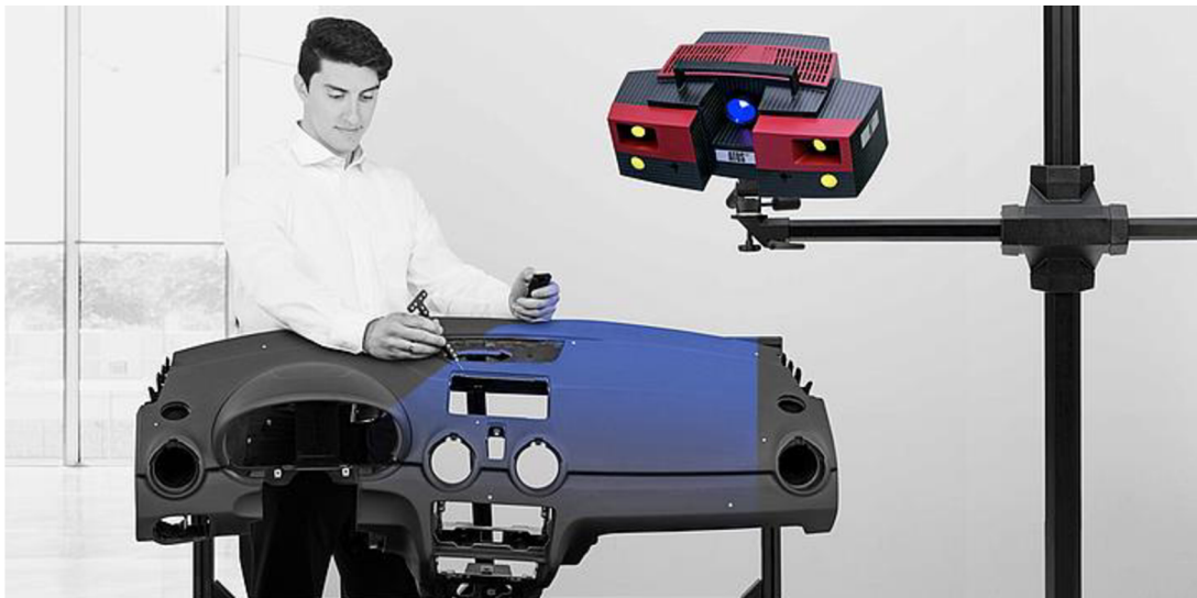
Obr. 3.16 ATOS skener jako trackovací zařízení [49]
