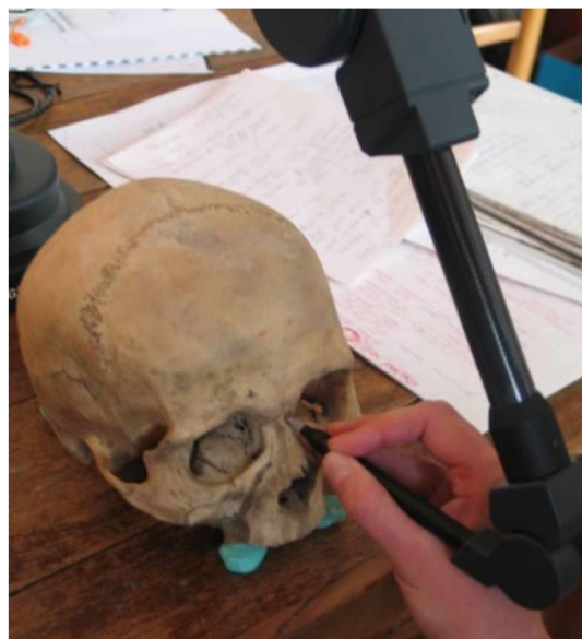
Obr. 3.10 Měření 3D souřadnice bodu pomocí MicroScribe G2X [44]
