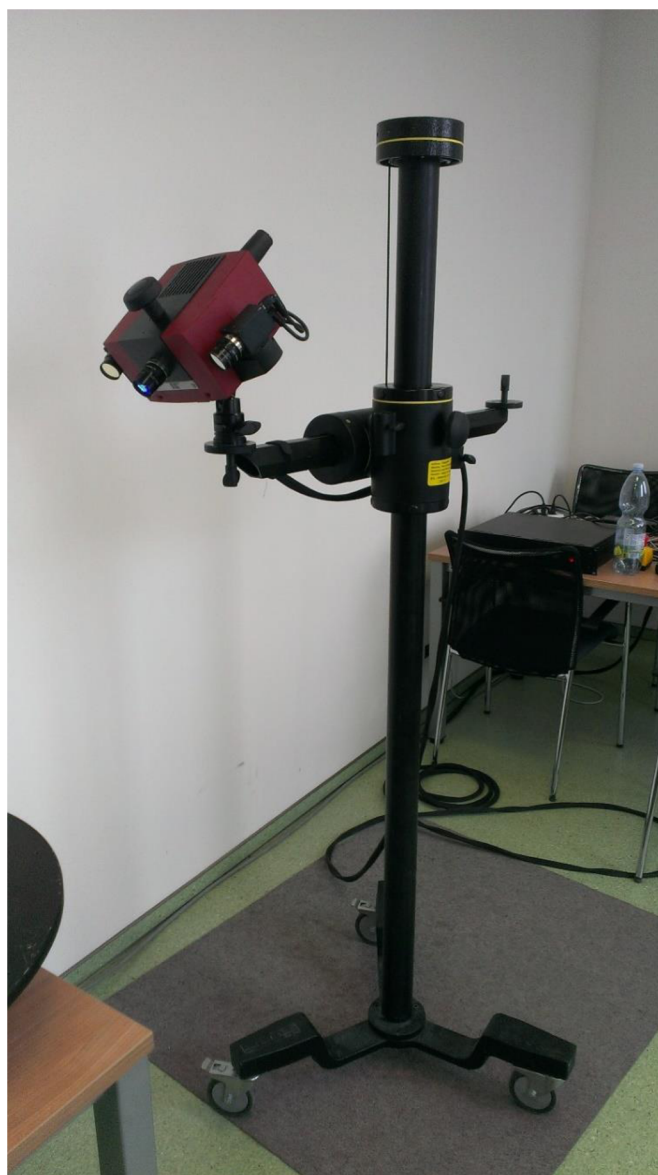
Obr. 4.3 Optický 3D skener ATOS Compact Scan
