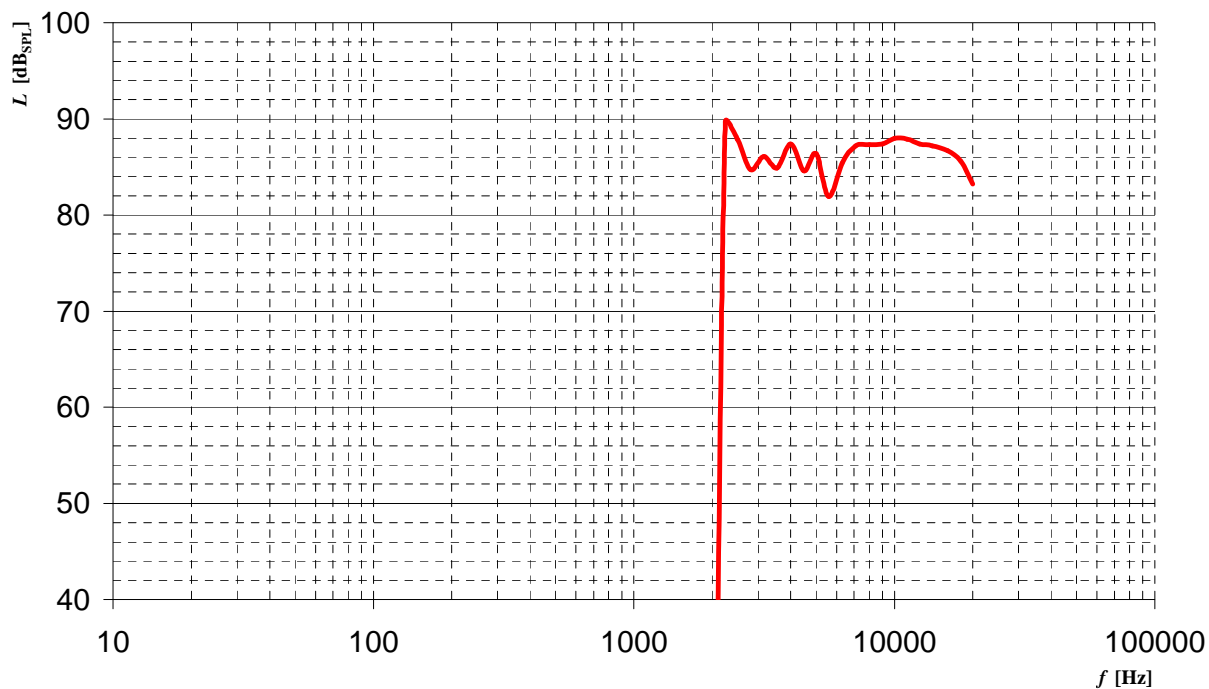
Obr. 7.3: Detail modulové kmitočtové charakteristiky vysokotónového reproduktoru.
