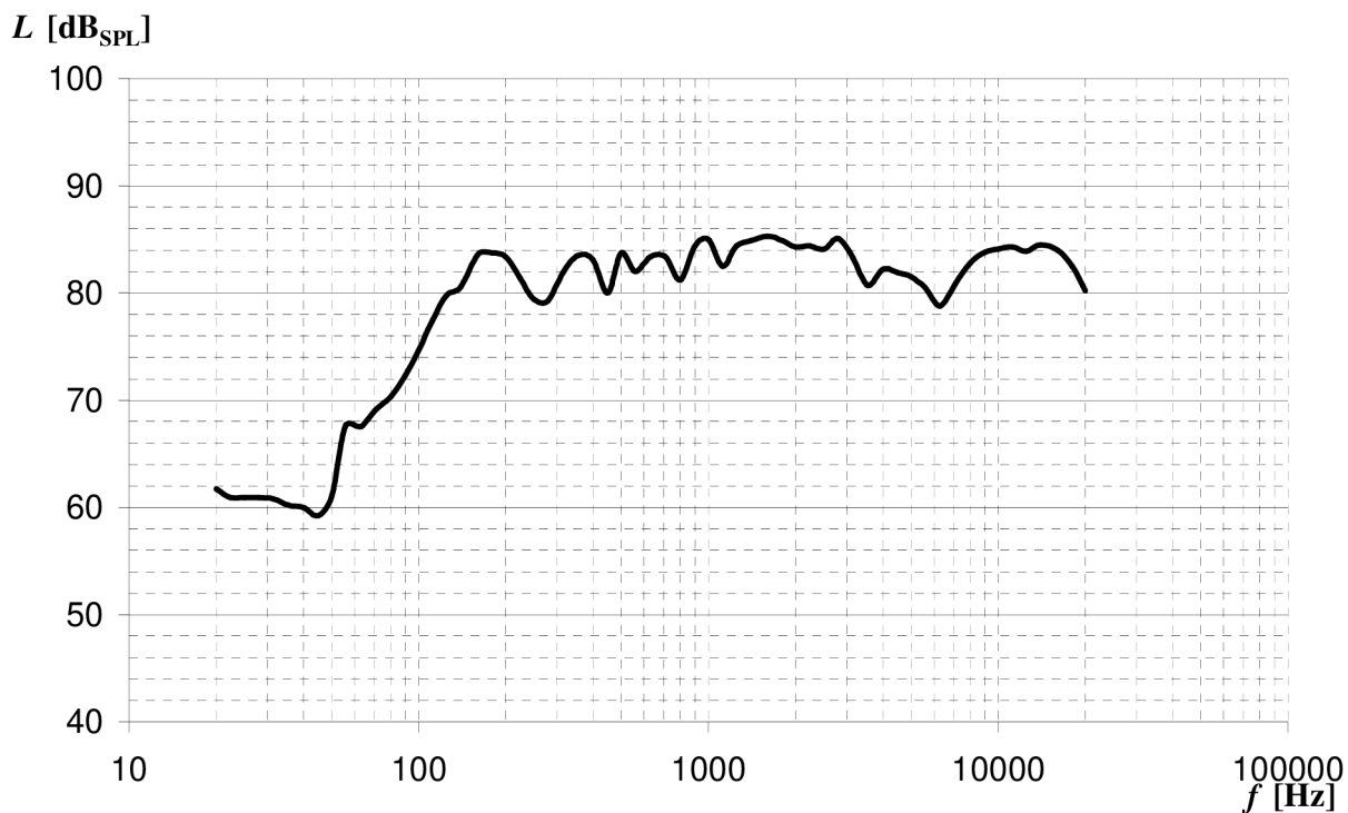
Obr. 7.2: Kmitočtová charakteristika navrhnuté reproduktorové soustavy.
