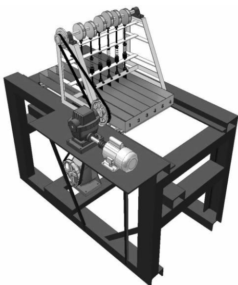
Obr. 2-4 Reciproční tribometr pro testování opotřebení
