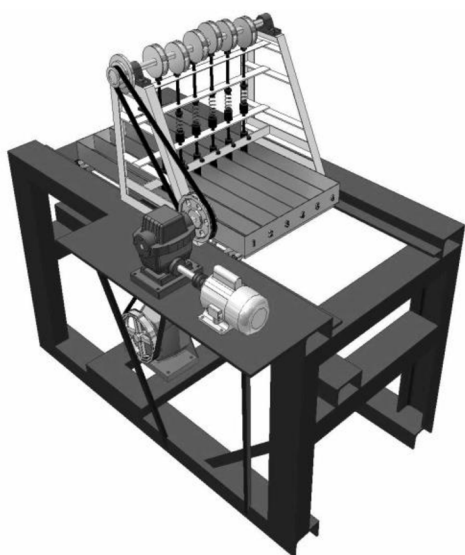
Obr. 2-4 Reciproční tribometr pro testování opotřebení
