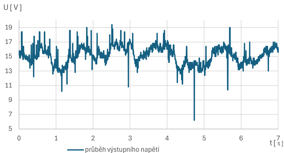
Obrázek 4.12 Detailní pohled na výstupní napětí zdroje BUCK
