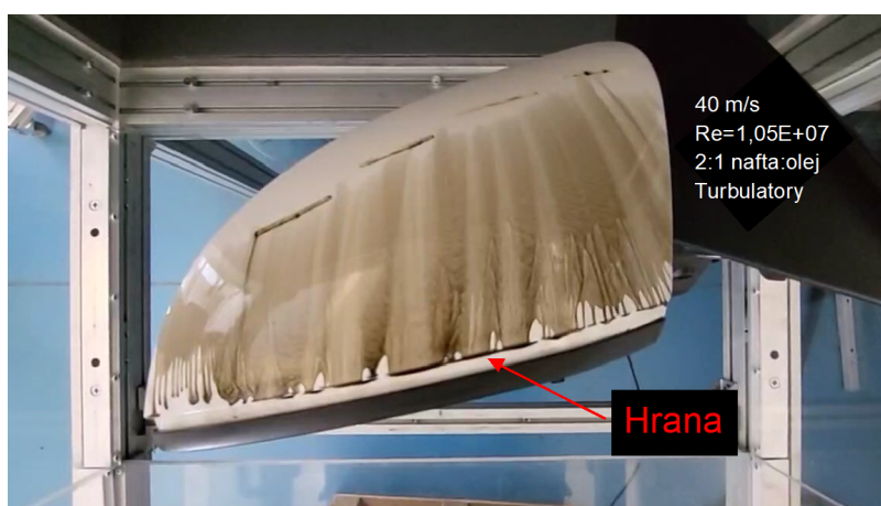
Obrázek 4.21: Zpětné zrcátko s turbulátory – oilflow
