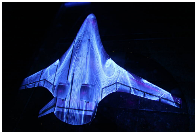
Obrázek 3.4: Vizualizace za použití fluorescenčního olejového filmu [10]
