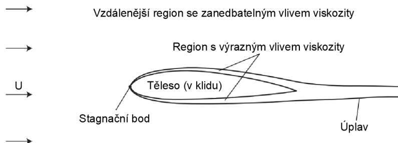
Obrázek 2.3: Schématické zobrazení regionů obklopujících obtékané těleso [12]
