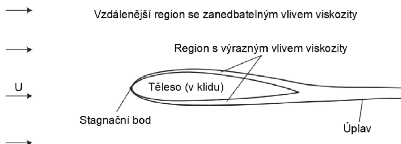
Obrázek 2.3: Schématické zobrazení regionů obklopujících obtékané těleso [12]
