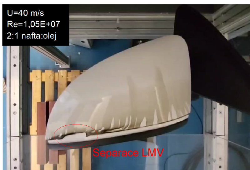
Obrázek 4.23: Zpětné zrcátko – olejový film
