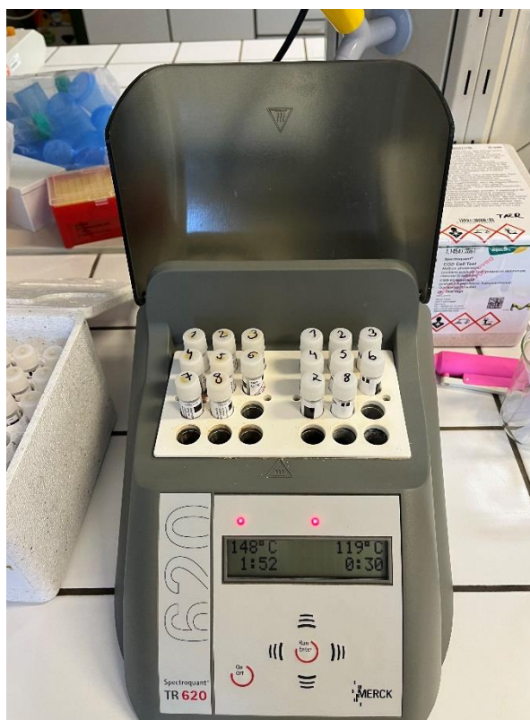
Obr. 18 Vzorky umístěné v termoreaktoru [58]
