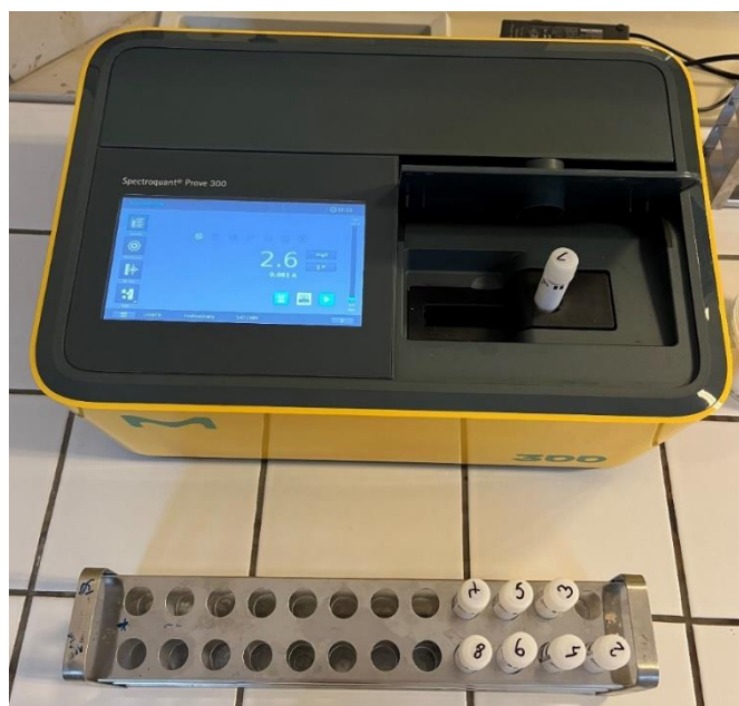
Obr. 20 Stanovení celkového fosforu ve vzorku pomocí fotometru [58]
