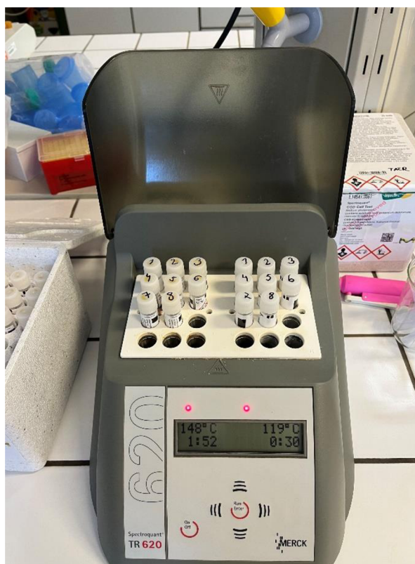
Obr. 18 Vzorky umístěné v termoreaktoru [58]
