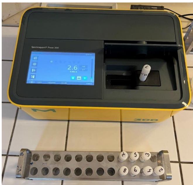
Obr. 20 Stanovení celkového fosforu ve vzorku pomocí fotometru [58]
