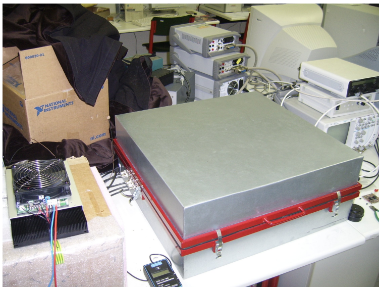
Fotografie 3: Opticky izolované oddělení, vpravo tepelně izolované oddělení s peltierovým článkem
