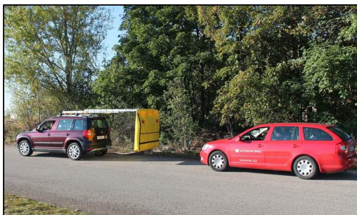
Obr. 19 Realizace měření na zkušebním úseku s využitím simulátoru jízdy v koloně [261]
