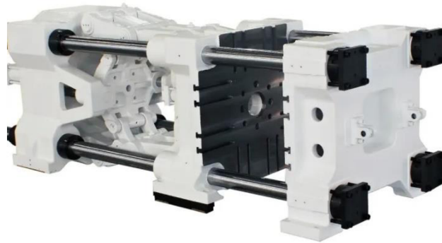
Obr. 20 Kloubový uzavírací systém [34].
