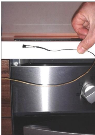
Obr. 24 Měření povrchové teploty dotykovým teploměrem Technoterm 9400 (vlastní knihovna)
