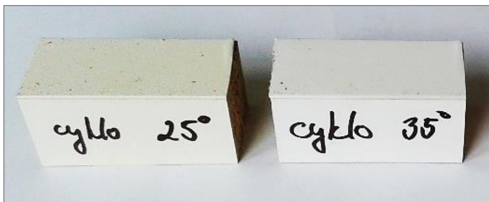
Obr. 53 Ukázka vzorků po testování smykového tlaku; vzorky zůstaly nezměněny (vlastní knihovna)
