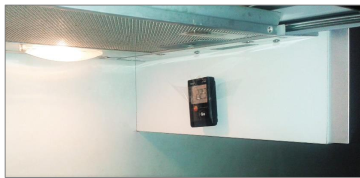
Obr. 25 Umístění dataloggeru v domácnosti (vlastní knihovna)
