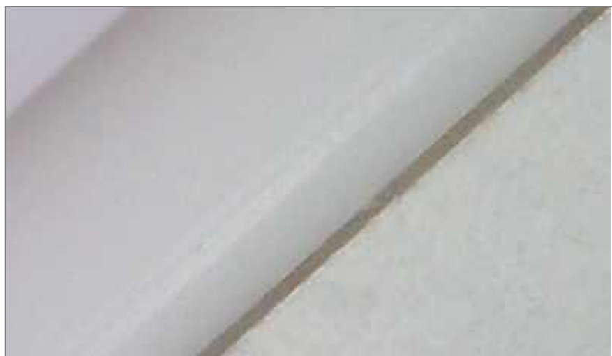
Obr. 12 Olepeno EVA lepidlem, tloušťka spáry 0,20 mm (Deibel a Meulbroek, 2009)
