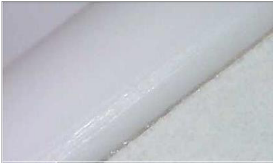
Obr. 11 Olepeno PUR lepidlem, tloušťka spáry 0,10 mm (Deibel a Meulbroek, 2009)
