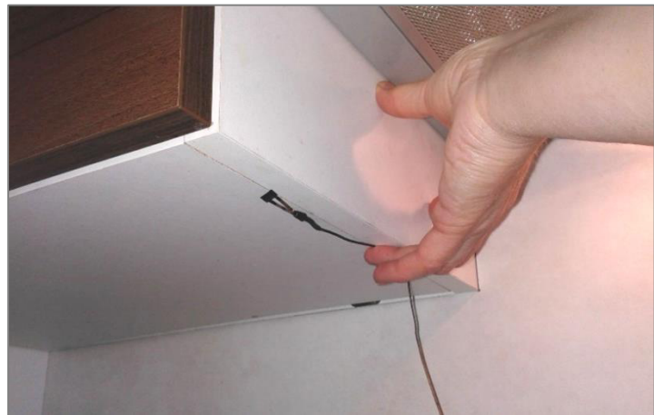
Obr. 24 Měření povrchové teploty dotykovým teploměrem Technoterm 9400 (vlastní knihovna)
