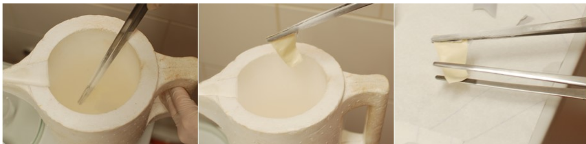
Obr. 4.6: Lámání membrán v kapalném dusíku
