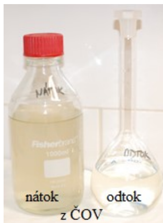
Obr. 4.5: Vzorky vody ČOV (nátok z nitrifikační nádrže, odtok z dosazovací nádrže)
