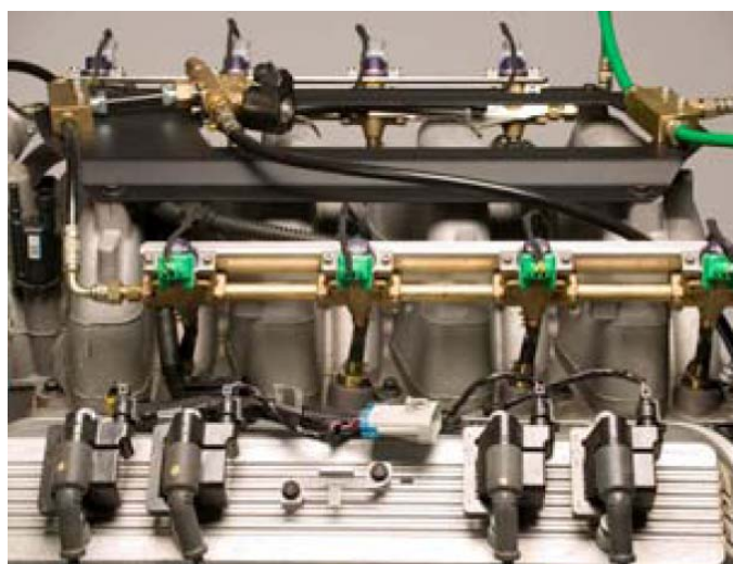
Obr. 27: Motor uzpůsobený pro spalování kapalného LPG
