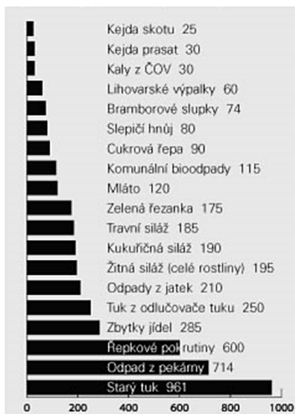
Obr. 29: Výnos bioplynu z tuny biomasy [2]
