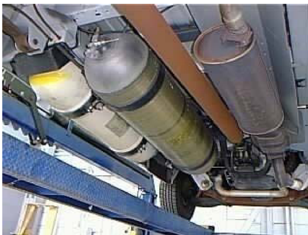
Obr. 55: Nádrž umístěná pod vozidlem
