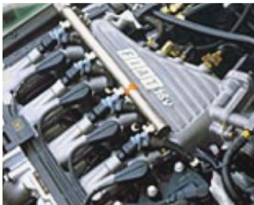
Obr. 57: Palivová lišta ve voze FIAT
