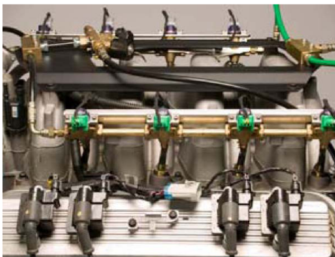
Obr. 27: Motor uzpůsobený pro spalování kapalného LPG
