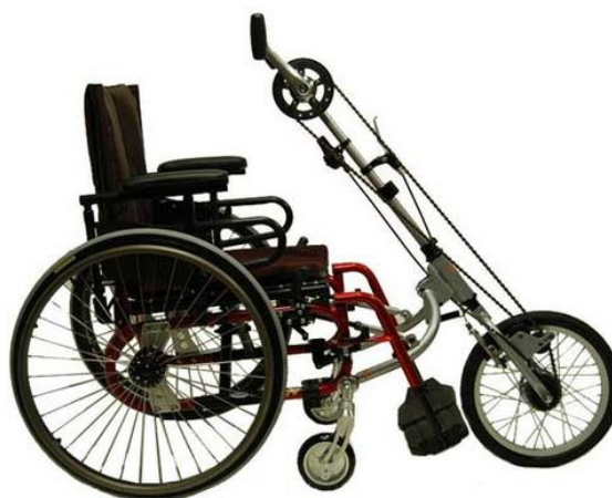
Obrázok 9. Pridavný adaptér na vozík (Zdroj: Benada & Zvonek, 2015).
