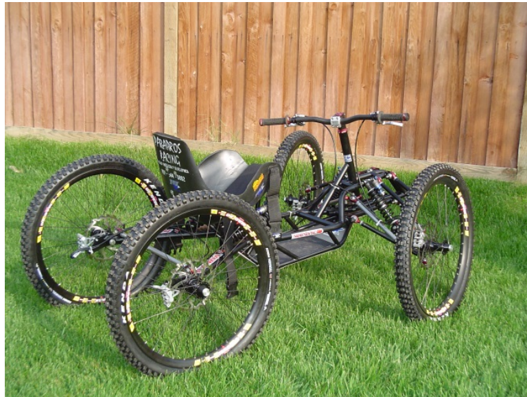
Obrázok 6. Sjazdový (down-hill) handbike (Benada & Zvonek, 2015).
