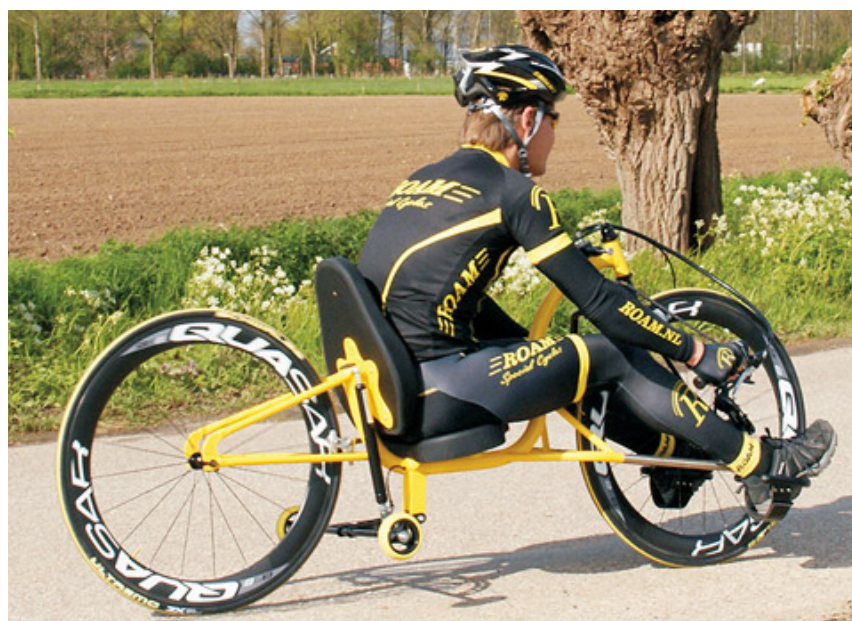
Obrázok 7. Jdnostopý handbike s pomocnými koleskami (Benada & Zvonek, 2015).
