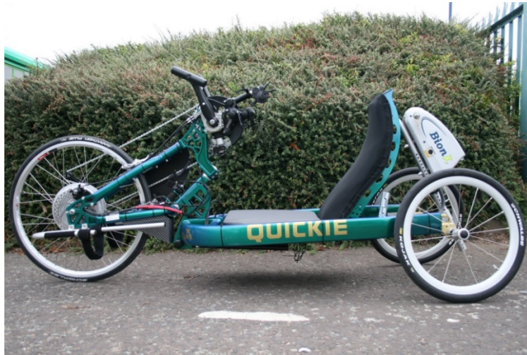
Obrázok 10. Handbike s prídavným elektromotorem (Benada & Zvonek, 2015).
