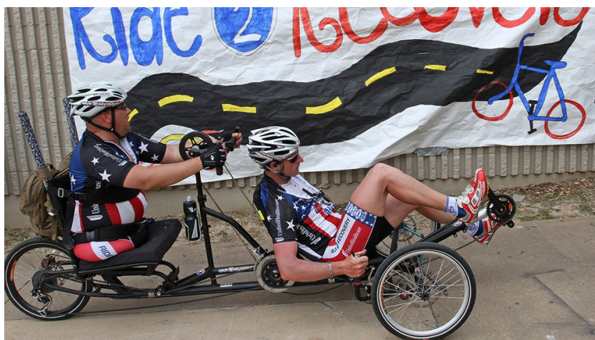
Obrázok 8. Tandem handbike v atypickém prevedení (Benada & Zvonek, 2015).
