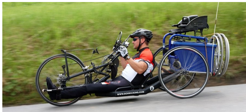
Obrázok 3. Cestný handbike s nosičem na vozík (Benada & Zvonek, 2015).
