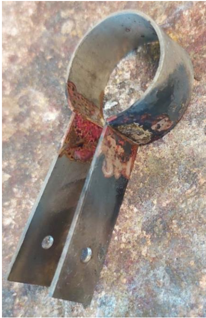
Obr. 40 Količek po tvrdém pájení
