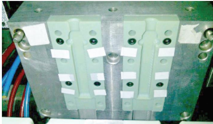
Obr. 2.2.10: Vytištěná vložka formy v kovovém rámu [4]
