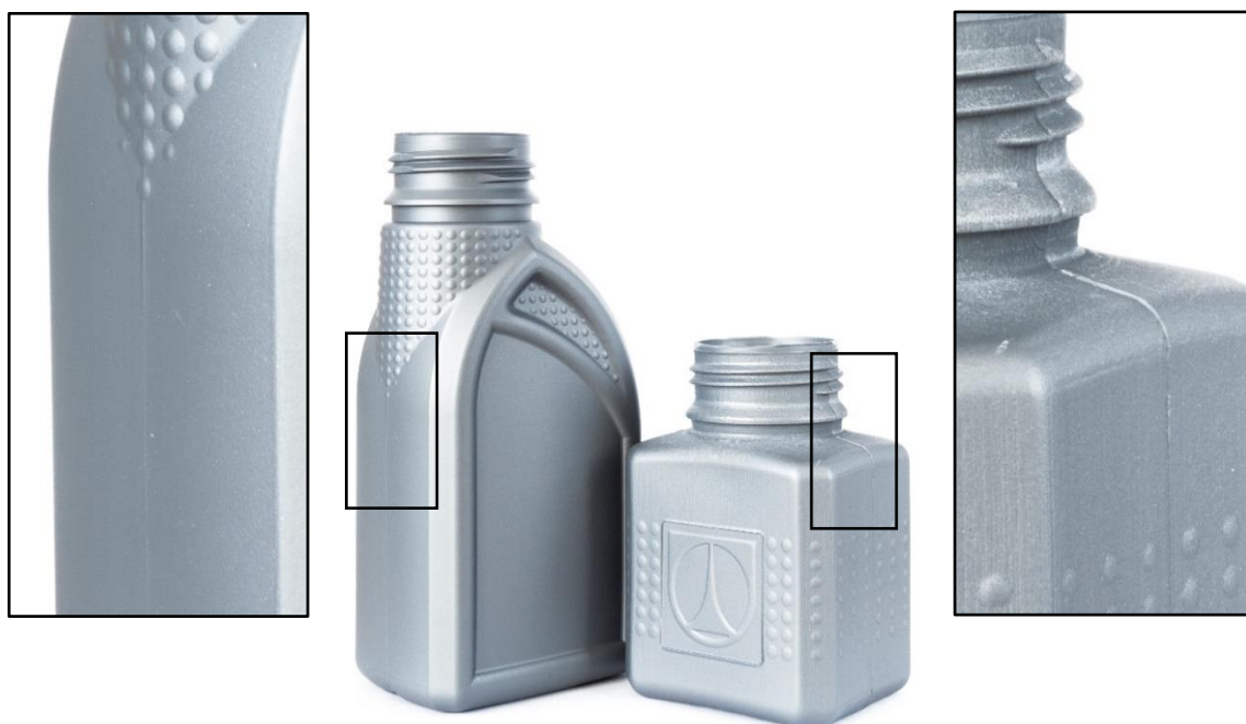
Obr. 4.3: Detail dělicí roviny výrobku z kovové formy (vlevo) a výrobku z prototypové formy PolyJet (vpravo)
