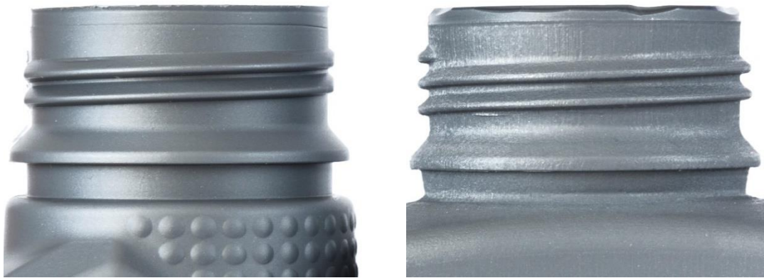
Obr. 4.4: Detail závitů výrobku z kovové formy (vlevo) a výrobku z prototypové formy PolyJet (vpravo)
