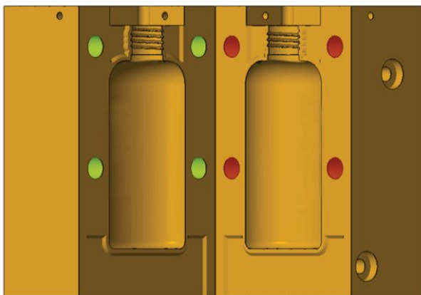
Obr. 2.2.8: Přidané otvory pro nalisování kovových nebo samostatně vytištěných vodících čepů (označeno červeně) [4]
