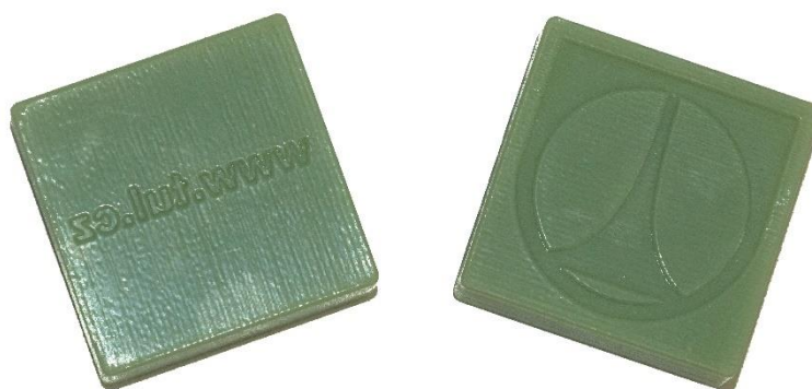
Obr. 3.3.4: Vyměnitelné vložky vyrobené technologií 3D tisku PolyJet
