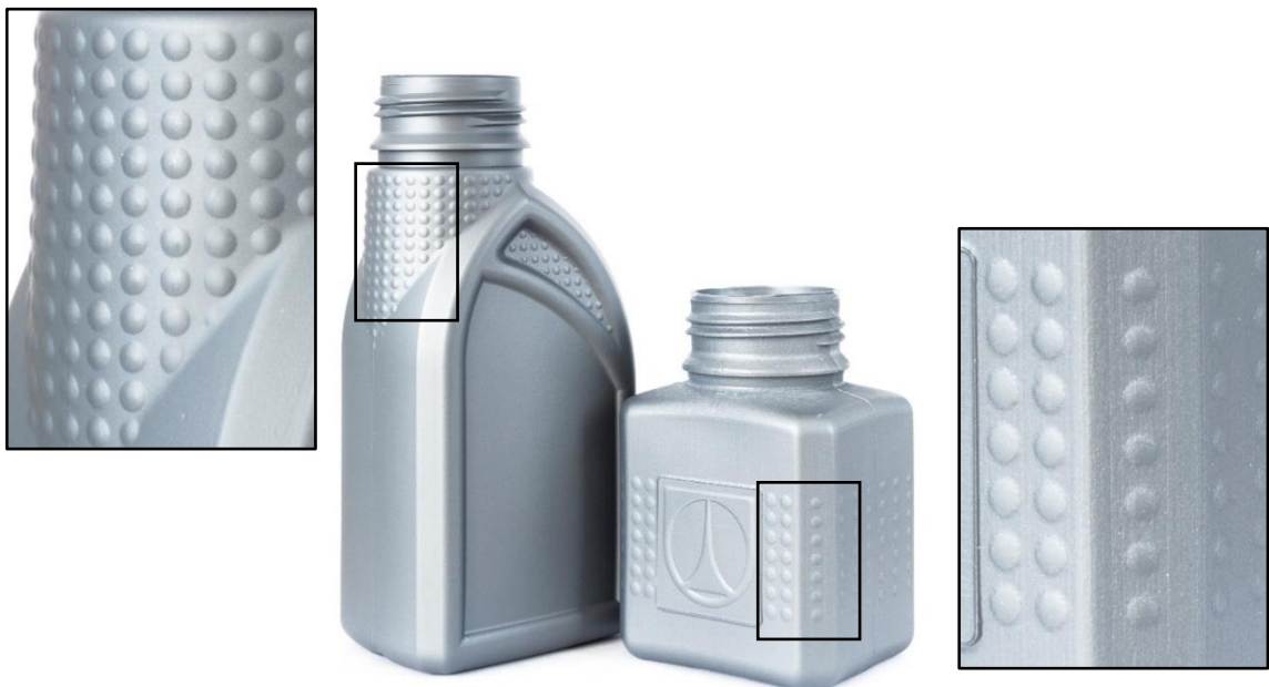
Obr. 4.5: Detail reliéfu výrobku z kovové formy (vlevo) a výrobku z prototypové formy PolyJet (vpravo)
