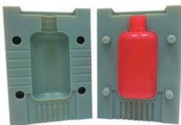
Obr. 2.2.2: Vyfukovací forma vytištěná technologií PolyJet [11]
