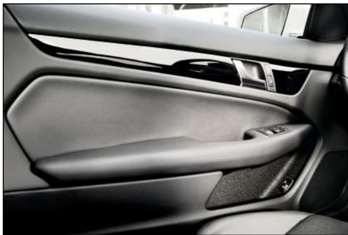
Obr. 20: Kašírovaný díl s kůží nalepenou na plastový nosič [23]
