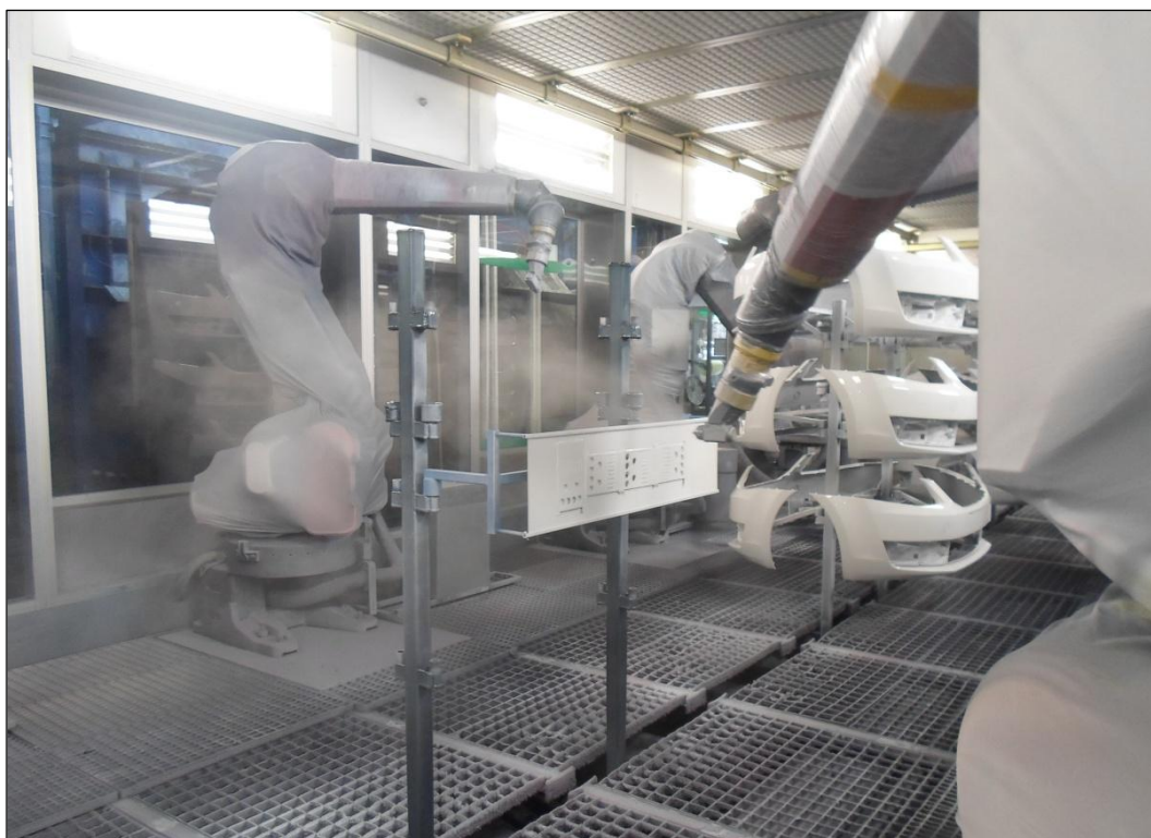
Obr. 30: Pohled do lakovací kabiny během lakování dílů bílou barvou
