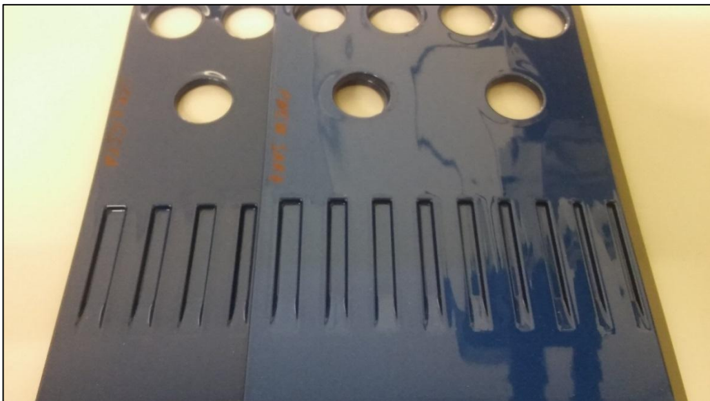
Obr. 35: Porovnání dvou totožných dílů s odlišnou vrstvou laku – vlevo slabší vrstva získaná elektrostatickou metodou, vpravo silnější vrstva získaná pneumatickou metodou
