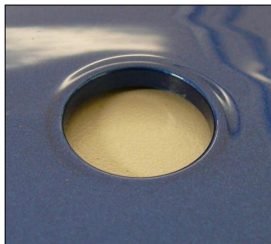
Obr. 33: Pouhým okem pozorovatelné důsledky zkoumaného jevu na modrém laku
