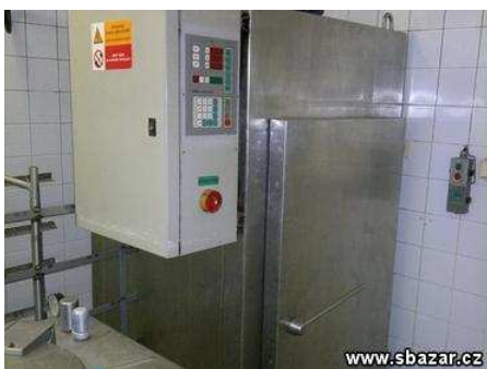
Obr. 10. Maloobjemová udírna MKU 1000
