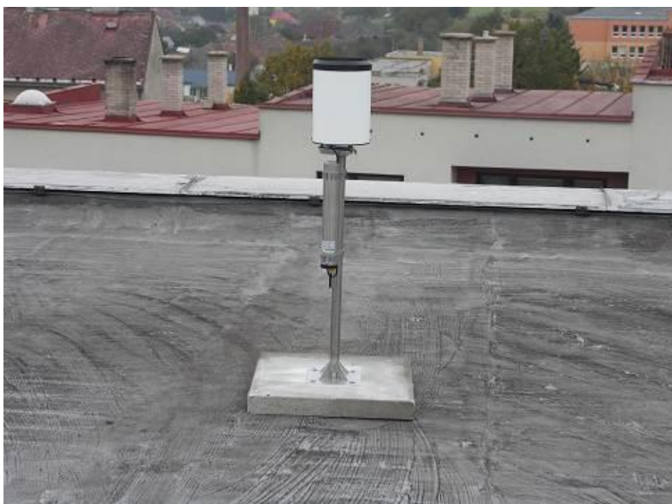
Obrázek 7 Navrhovaný srážkoměr, zdroj: Magistrát města Jihlavy, vodoprávní úřad, listopad 2012.
