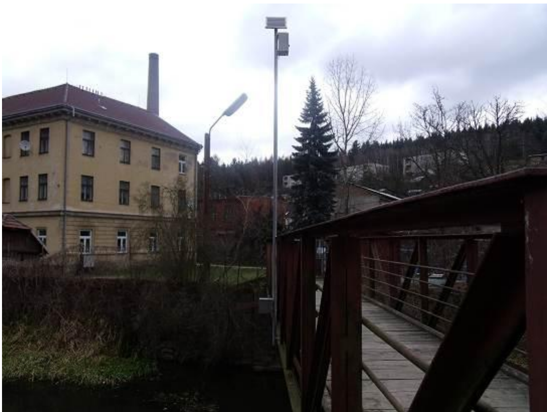
Obrázek 14 Hladinoměr s ultrazvukovým snímačem v Malém Beranově, zdroj: Magistrát města Jihlavy, vodoprávní úřad, listopad 2012.
