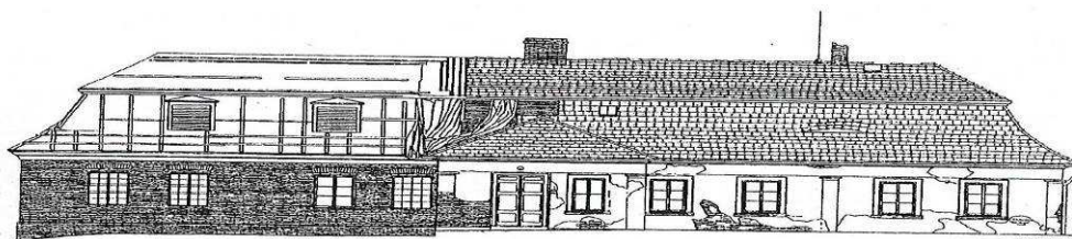
Voděrádky (Praha-východ), jihozápadní průčelí zámecké budovy. Kresba dokumentuje špatný stav střešní krytiny a fasád. Stav v květnu 2002, kresba Robert Vejvoda.
