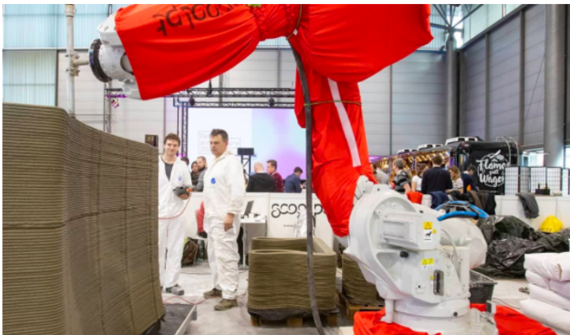
Obrázek 2.3: 3D tiskárna s robotickou rukou[17]
