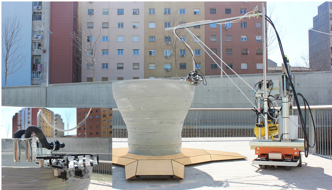
Obrázek 2.4: mobilní 3D tiskárna [2]
