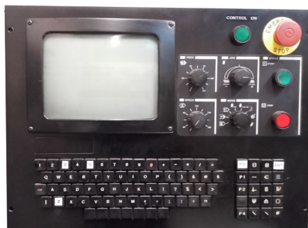
Obrázek 1.1: HMI s CRT obrazovkou [15]
