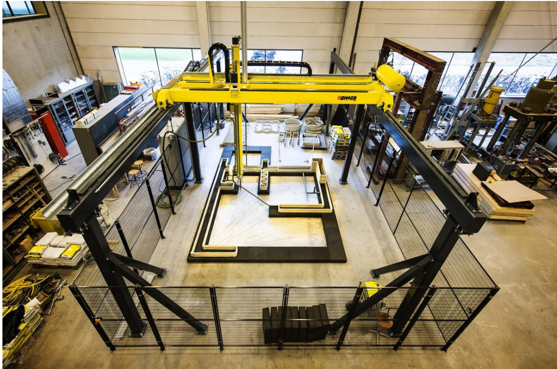
Obrázek 2.2: portálová 3D tiskárna [2]
