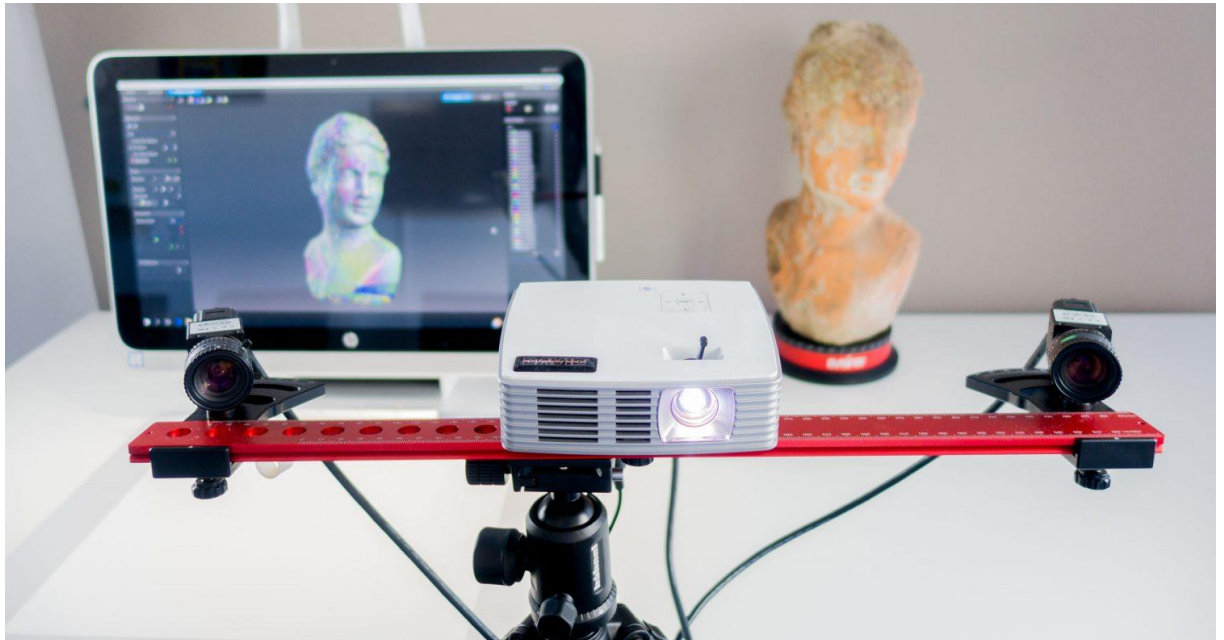
Obrázek 5 - Metoda strukturovaného světla (3D triangulace)
