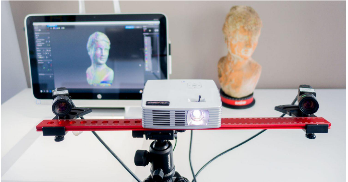
Obrázek 5 - Metoda strukturovaného světla (3D triangulace)
