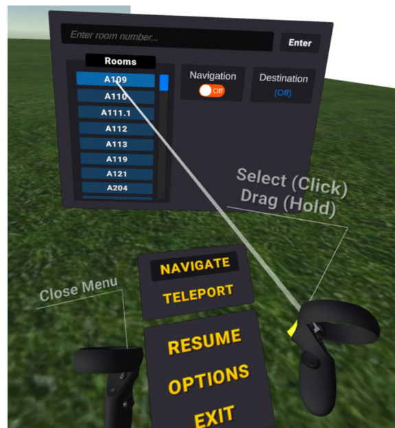
Obrázek 4.15: Na obrázku lze vidět klasickou nápovědu pro ovladače s otevřeným menu
