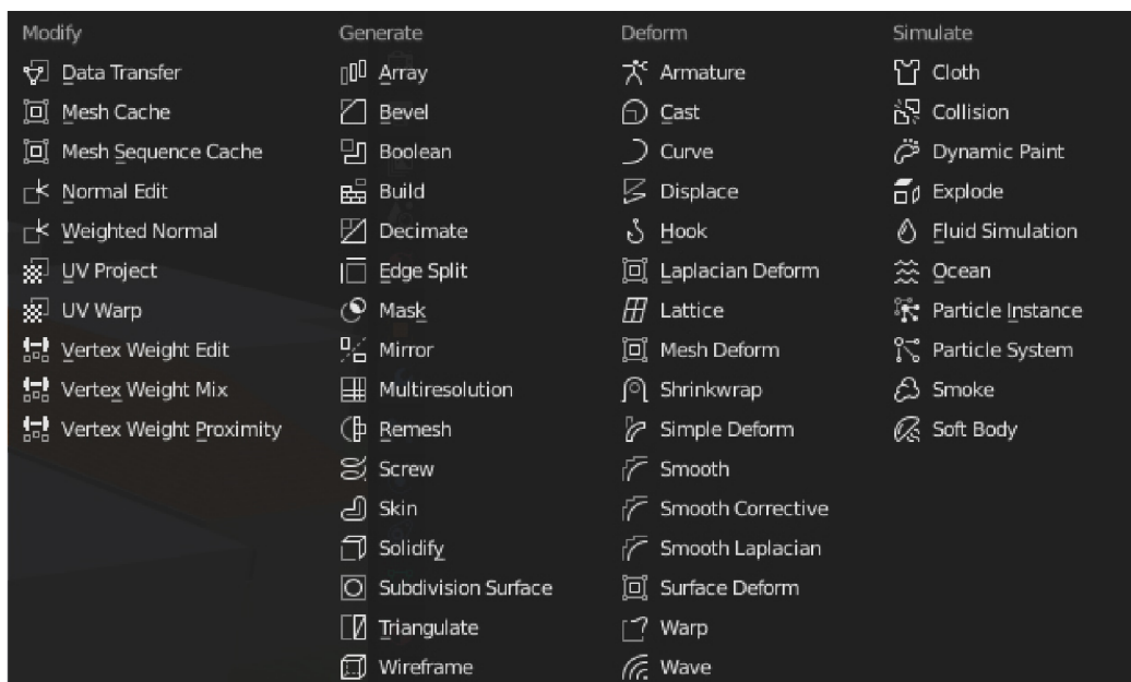
Obrázek 3.11: Na obrázku je vidět seznam modifikátorů pro Blender 2.8, které usnadňují práci s modelováním objektů. Podrobněji v sekci 3.2.2.
