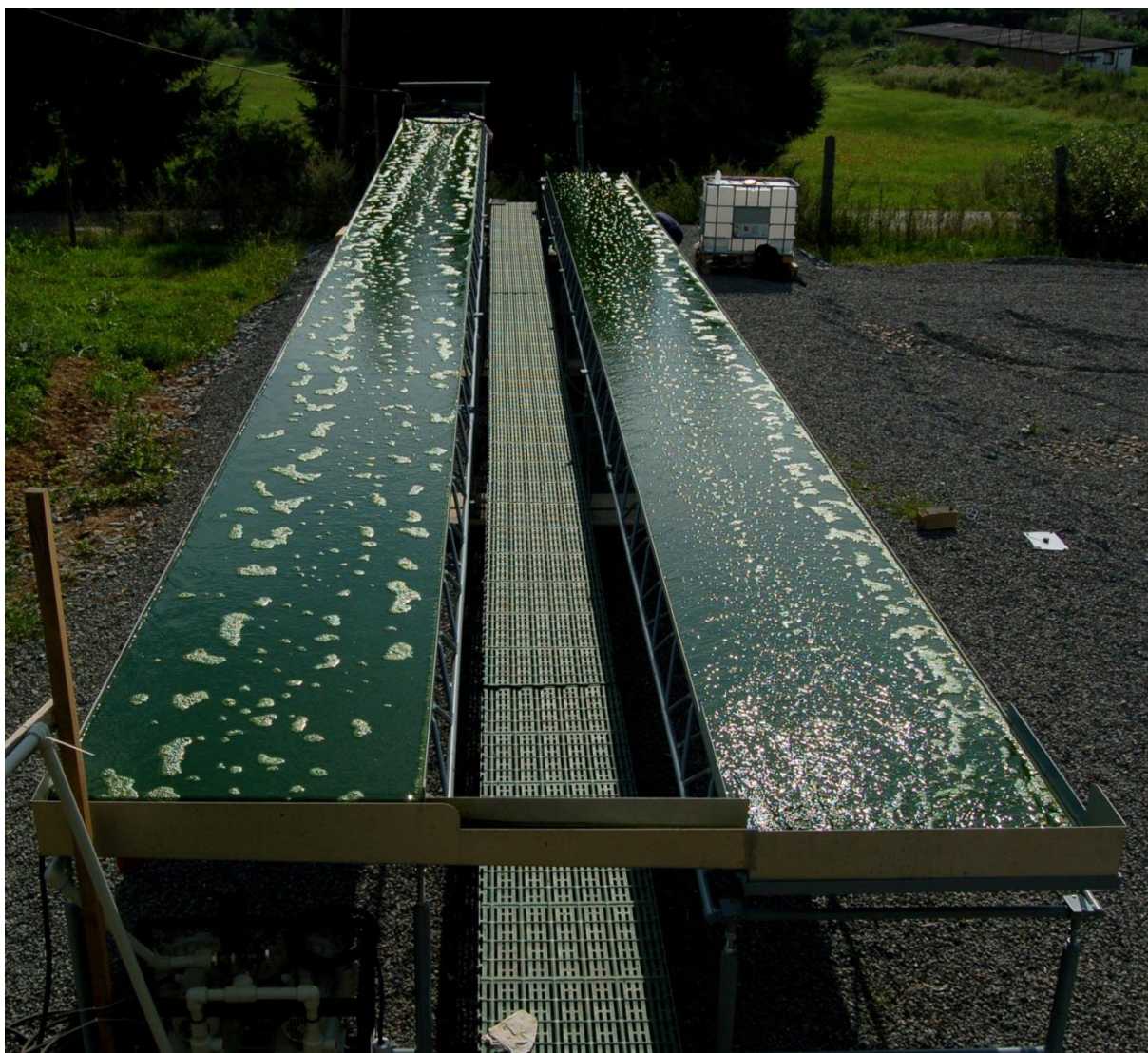
Obrázek 8: Fotobioreaktor (BCS Engineering,a.s., Česká republika) umístěný v Zemědělské společnosti Dublovice a.s.
