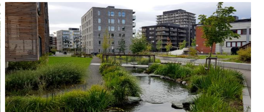
Obr. 37-39: Ensjøbyen je megaprojekt čtvrti v Oslu, který je v rámci zeleno-modré infrastruktury téměř světový unikát. Různorodé dešťové prvky jsou tu vzájemně propojeny. Vodní plocha prostředního obrázku zachytává dešťovou vodu z místních střech a přebytek vody díky gravitaci stéká dál do městského potoka nové čtvrti, zobrazeného na posledním obrázku. Potok dešťovou vodu zpomaluje, pročišťuje a propojuje prvky budované infrastruktury.
