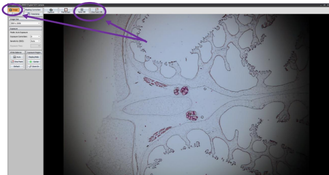
Obr. 17: Nové otevřené okno, ve kterém probíhá pořizování snímku (zvětšení 4x). Fialově zvýrazněna ikona na pořizování snímků „Capture“ (vlevo) a ikony na vyvážení bílé barvy (vpravo).
