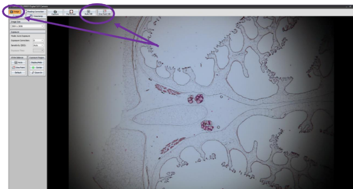
Obr. 17: Nové otevřené okno, ve kterém probíhá pořizování snímku (zvětšení 4x). Fialově zvýrazněna ikona na pořizování snímků „Capture“ (vlevo) a ikony na vyvážení bílé barvy (vpravo).
