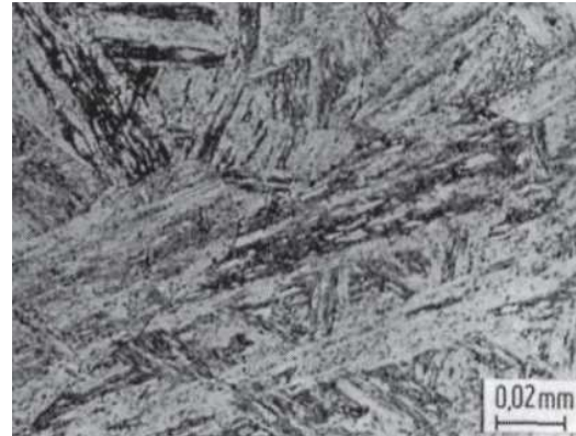
Obr. 27 Mikrostruktura martenzitické oceli [39].
