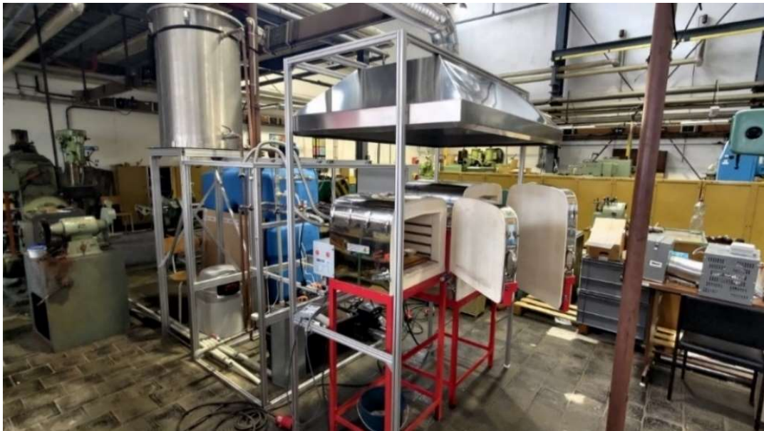
Obr. 4 Testovací zařízení pro simulaci vysokoteplotní koroze [11].
