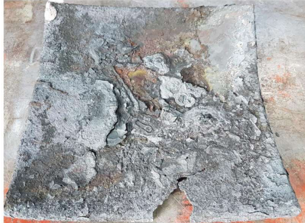
Obr. 38 Nádoba z EN 1.4841 po 24 hodinách v peci [47].
