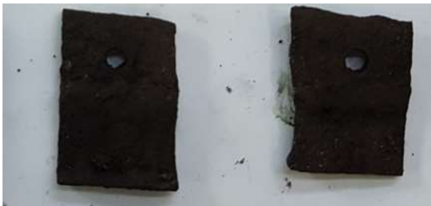
Obr. 61 Vzorky 7 a 8 z 16Mo3 v čase T = 60 min při 1 050 °C [61].
