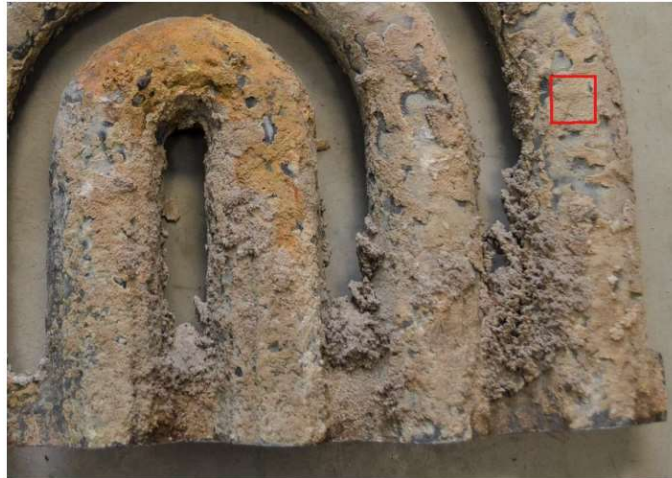
Obr. 31 Zkorodovaná součást ze spalovny s označeným místem pro chemickou analýzu [47].
