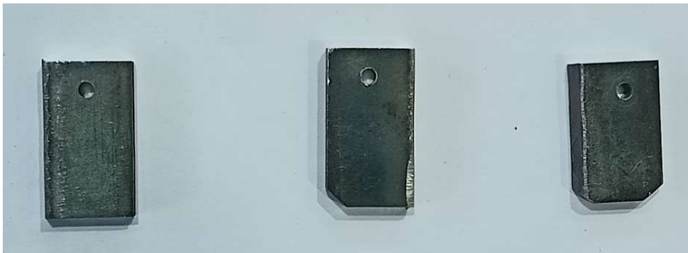
Obr. 44 Vzorky 1-3 z 16Mo3 v čase T = 0 min při 900 °C.
