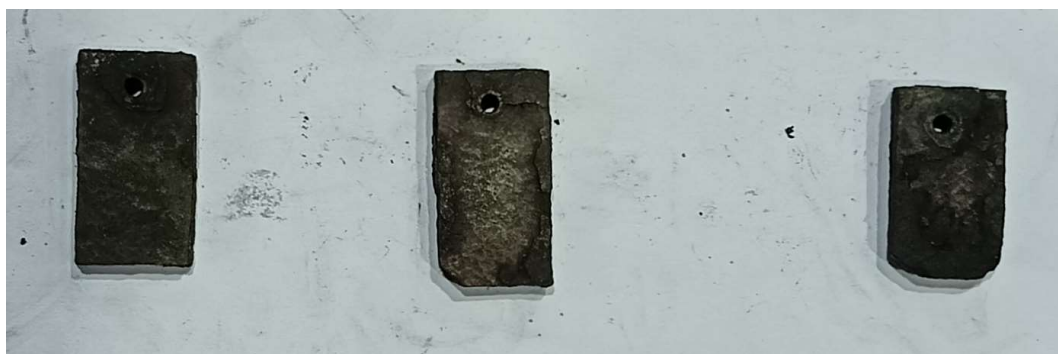
Obr. 47 Vzorky 1–3 z 16Mo3 v čase T = 280 min při 900\text{ °C} .
