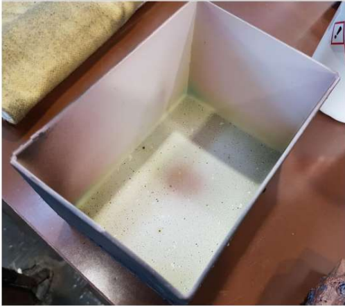
Obr. 37 Nádoba z EN 1.4841 po 2 hodinách v peci [47].
