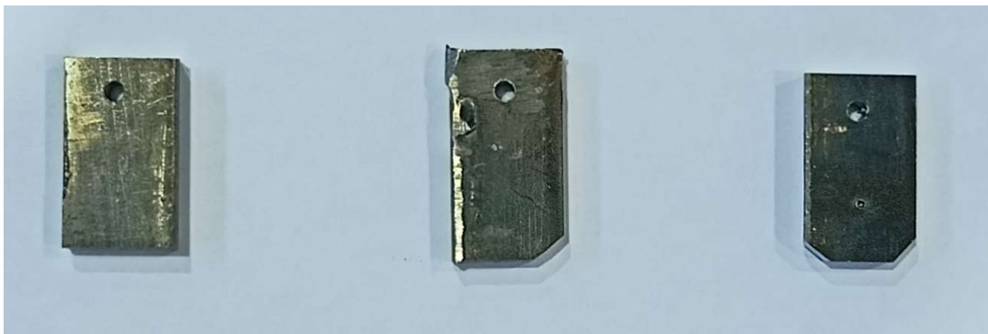
Obr. 52 Vzorky 4–6 z 16Mo3 v čase T = 0 min při 975 °C.
