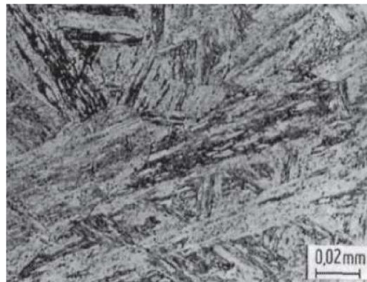
Obr. 27 Mikrostruktura martenzitické oceli [39].
