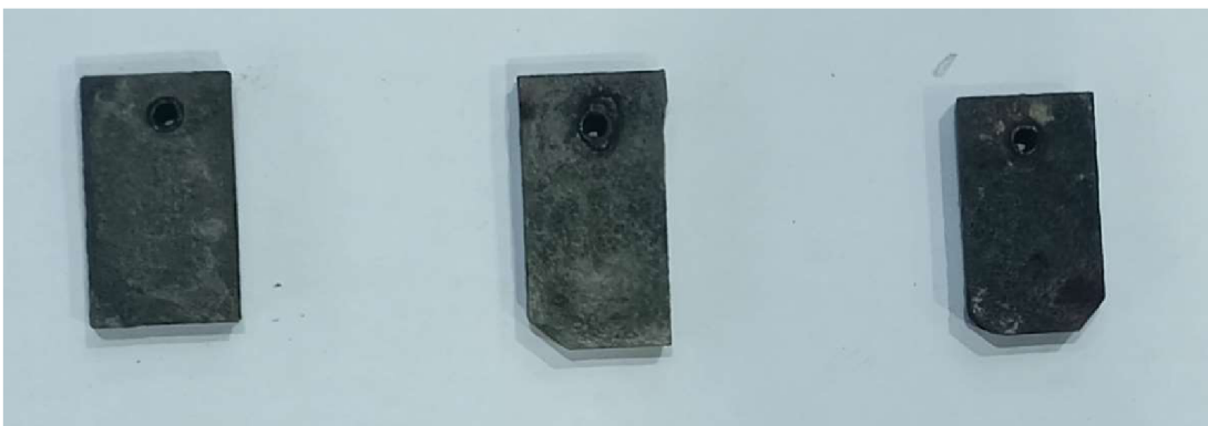
Obr. 53 Vzorky 4-6 z 16Mo3 v čase T = 80 min při 975 °C.
