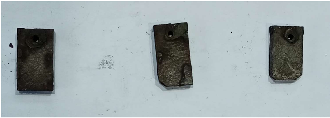
Obr. 46 Vzorky 1–3 z 16Mo3 v čase T = 180 min při 900\text{ °C} .
