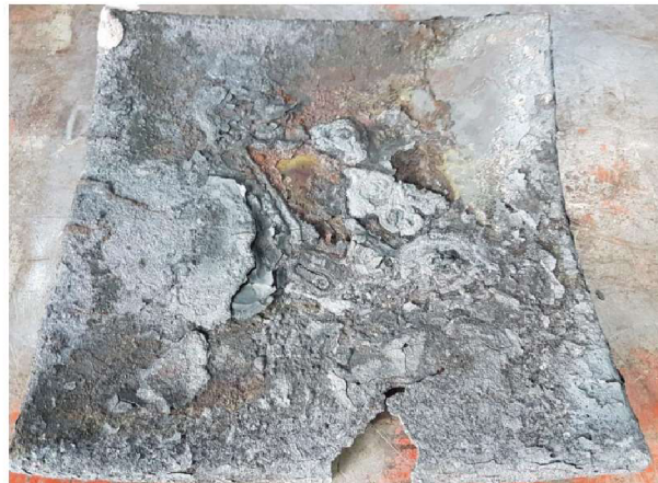
Obr. 38 Nádoba z EN 1.4841 po 24 hodinách v peci [47].
