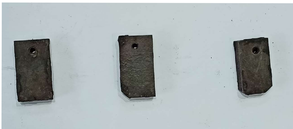
Obr. 45 Vzorky 1-3 z 16Mo3 v čase T = 80 min při 900 °C.
