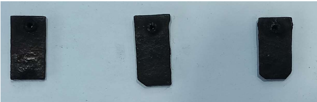
Obr. 55 Vzorky 4–6 z 16Mo3 v čase T = 280 min při 975 °C.
