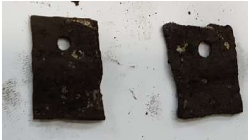
Obr. 62 Vzorky 7 a 8 z 16Mo3 v čase T = 120 min při 1\ 050\ ^\circ\text{C} [61].
