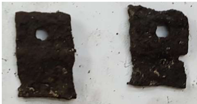
Obrázek 63 Vzorky 7 a 8 z 16Mo3 v čase T = 180 min při 1\ 050\ ^\circ\text{C} [61].
