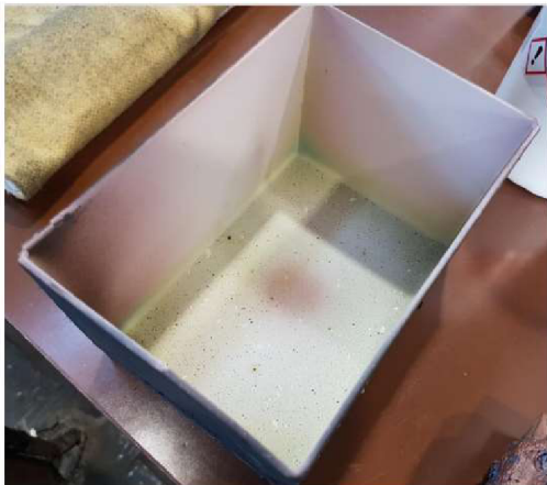
Obr. 37 Nádoba z EN 1.4841 po 2 hodinách v peci [47].
