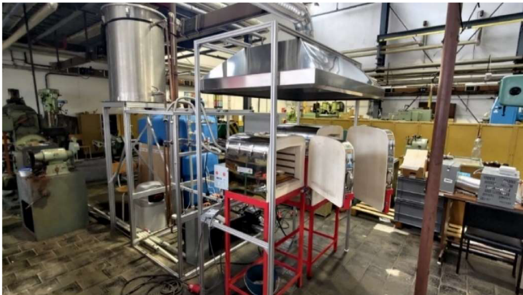
Obr. 4 Testovací zařízení pro simulaci vysokoteplotní koroze [11].
