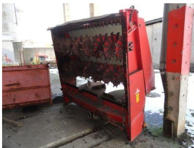
Obrázek 28: Detail rozmetacího ústrojí
