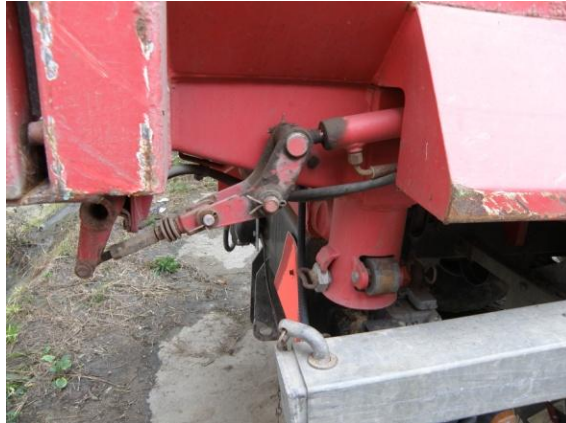
Obrázek 24: Hydraulický separátní válec
