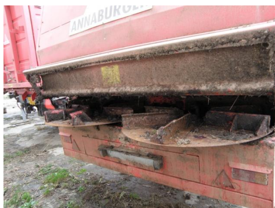
Obrázek 27: Dvoukotoučové rozmetací ústrojí
