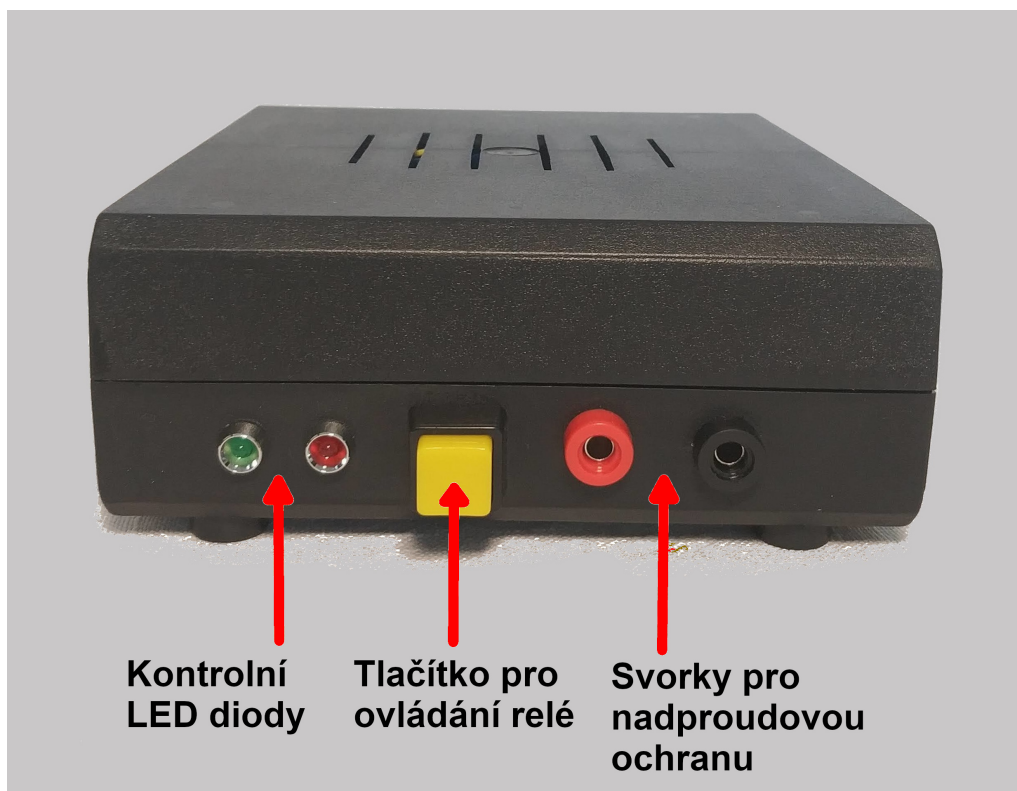
Obr. 5.6: Čelní panel monitorovacího zařízení (v laboratoři umístěno na výšku)
