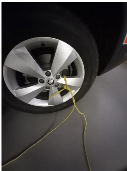
Obrázek 23: Vyvážení lana za disk kola vozu. Zdroj: FRANK, Michal, 2024, HZS JHM
