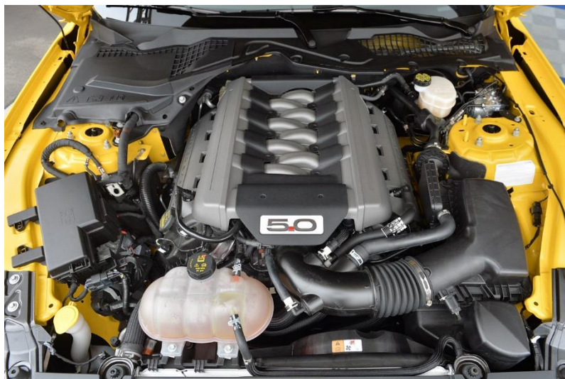
Obr 1 Uložení sacího potrubí vozu Ford Mustang 2015 [17]
