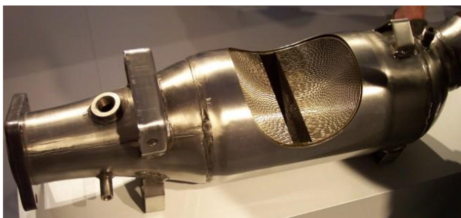
Obr 13 Řez třicestným katalyzátorem s kovovým jádrem [27]
