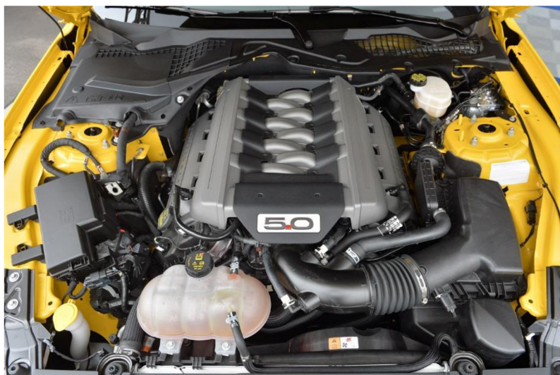
Obr 1 Uložení sacího potrubí vozu Ford Mustang 2015 [17]
