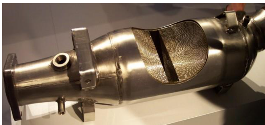
Obr 13 Řez třicestným katalyzátorem s kovovým jádrem [27]
