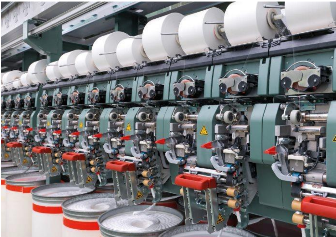
Obrázek 8 Tryskový dopřádací stroj Rieter J 26 [13]
