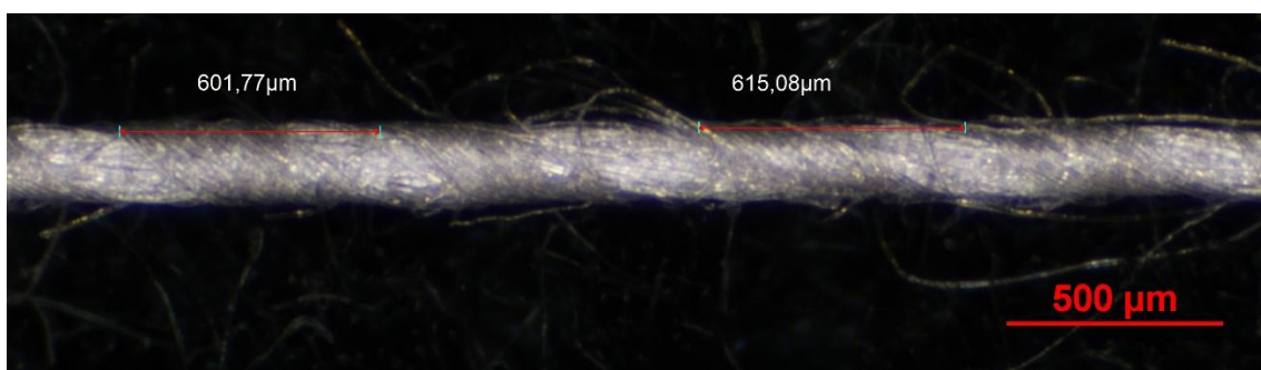
Obrázek 16 Měření výšky stoupání šroubovice v programu obrazové analýzy NIS Elements
