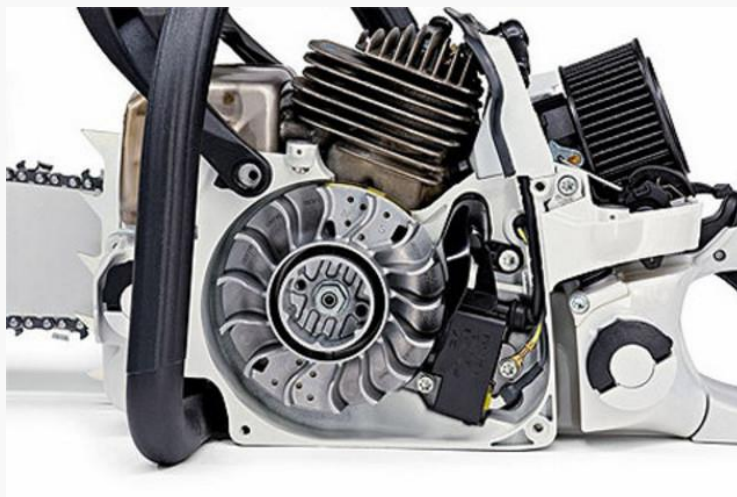
Obr. 2 Motor profesionální MP Stihl, ( http://www.stihl-cerman.cz )
