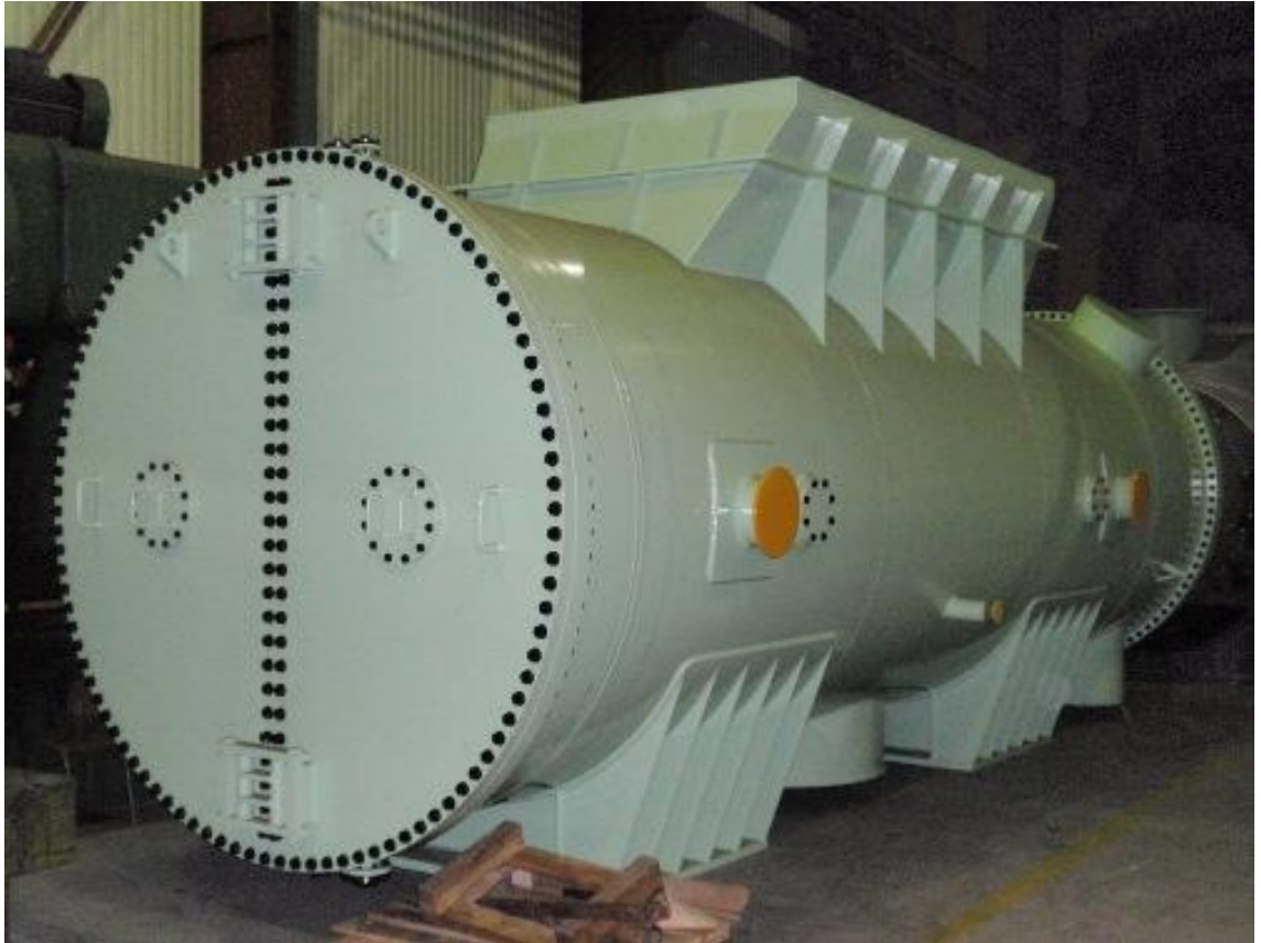
Obr. 22 Vstupní potrubí páry obdélníkového průřezu [13]
