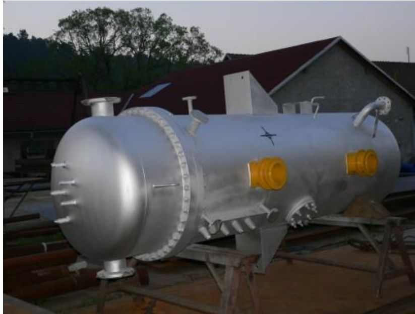
Obr. 3 První varianta KUP – teplosměnná plocha 19 m 2 [13]
