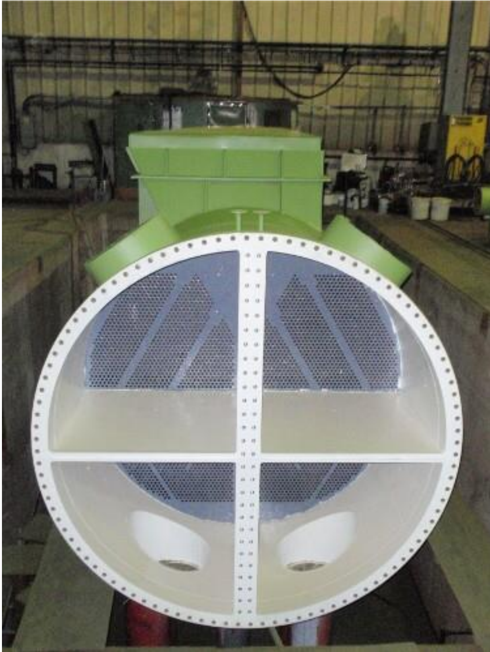
Obr. 21 Realizace trubkového svazku s pohledem na vstupní a výstupní komory [13]
