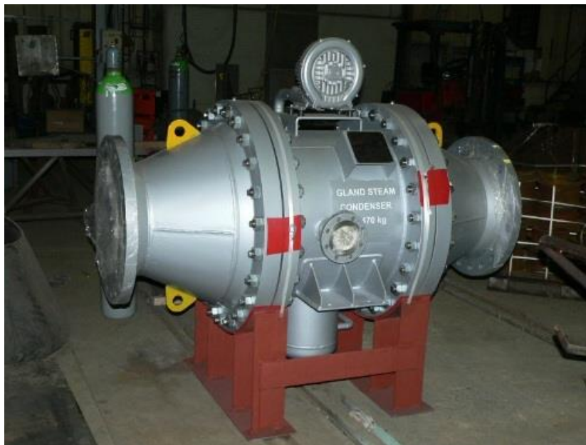
Obr. 4 Druhá varianta KUP – teplosměnná plocha 20 m 2 [13]
