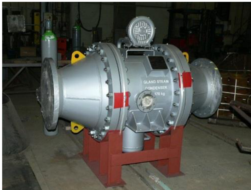
Obr. 4 Druhá varianta KUP – teplosměnná plocha 20 m 2 [13]
