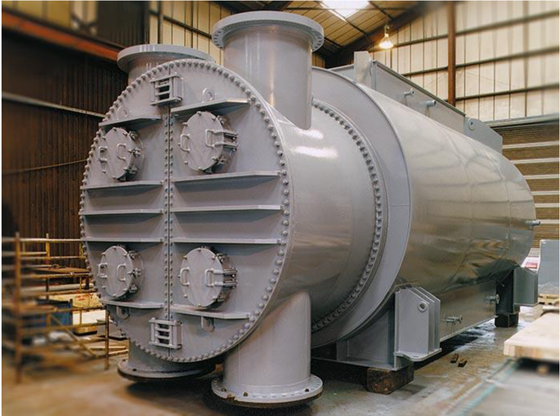
Obr. 24 Kondenzátor s velkoplošným hranatým sběračem kondenzátu [11]
