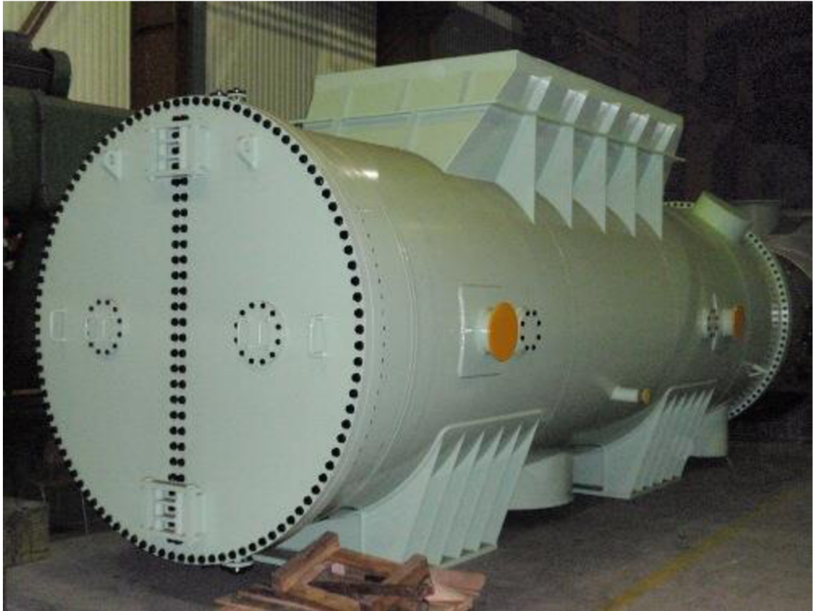
Obr. 22 Vstupní potrubí páry obdélníkového průřezu [13]
