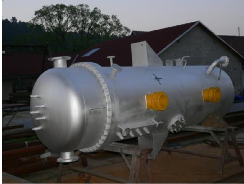
Obr. 3 První varianta KUP – teplosměnná plocha 19 m 2 [13]
