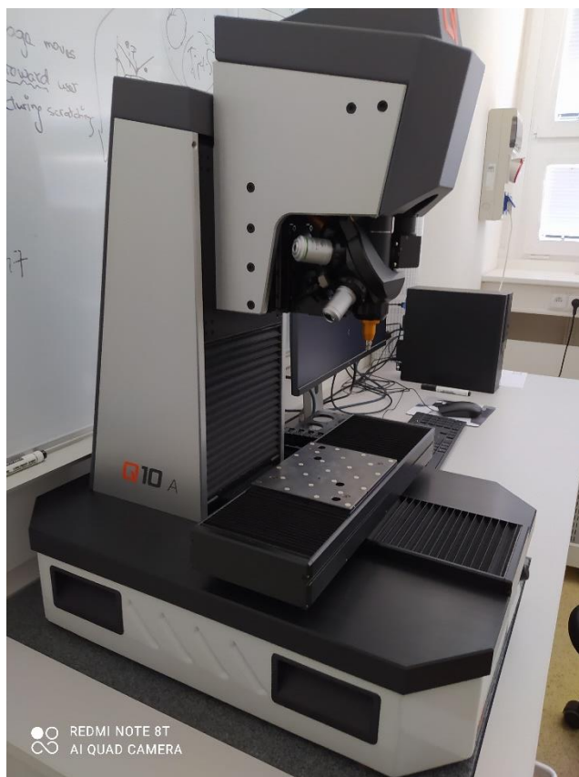
Obr. 2.2 Přístroj Qness Q10A na měření mikrotvrdoti.
