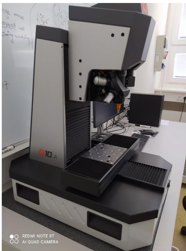
Obr. 2.2 Přístroj Qness Q10A na měření mikrotvrdoti.
