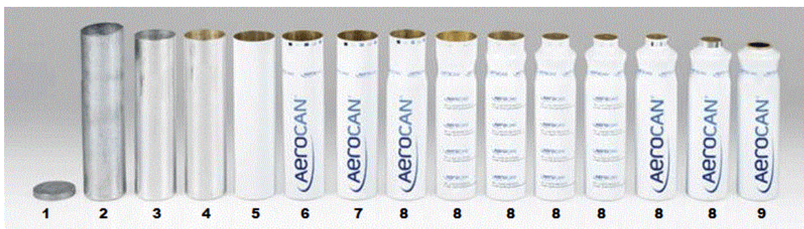
Obrázek 19 – Schéma procesu výroby hliníkového pouzdra na aerosolové spreje [38]
