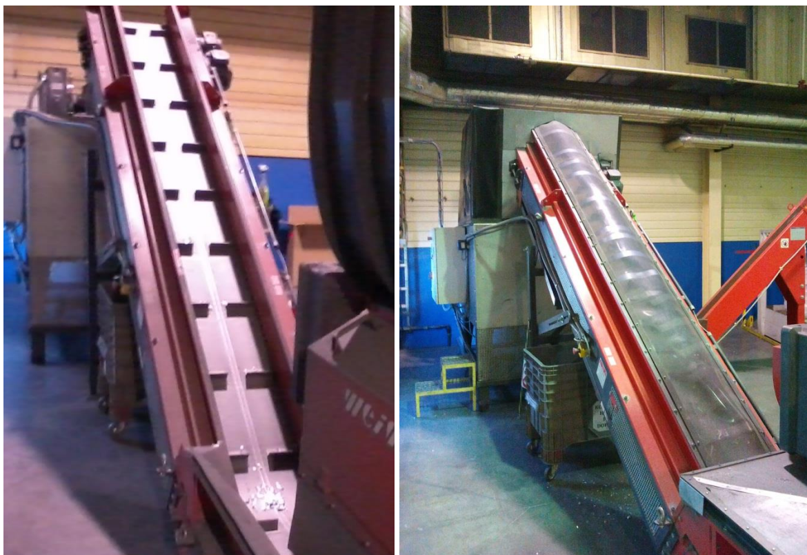
Příloha 1 – Obrázek 2 – Fotografie pásového dopravníku před úpravou a po úpravě [foto autor]
