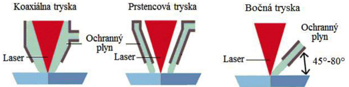
Obr. 23 Spôsoby dopravy ochranného plynu [36]
