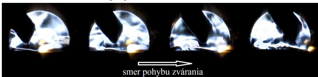
Obr. 35 Prúdenie zmesnej ochrannej atmosféry 97\text{Ar} + 3\text{CO}_2 v smere zvarania pri rýchlosti zvarania 5\text{mm}\cdot\text{s}^{-1}
