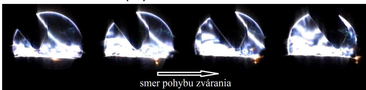
Obr. 33 Prúdenie argónovej ochrannej atmosféry v smere zvarania pri rýchlosti zvarania 5\text{mm}\cdot\text{s}^{-1}
