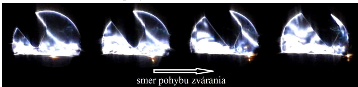
Obr. 33 Prúdenie argónovej ochrannej atmosféry v smere zvarovania pri rýchlosti zvarovania 5\text{mm}\cdot\text{s}^{-1}
