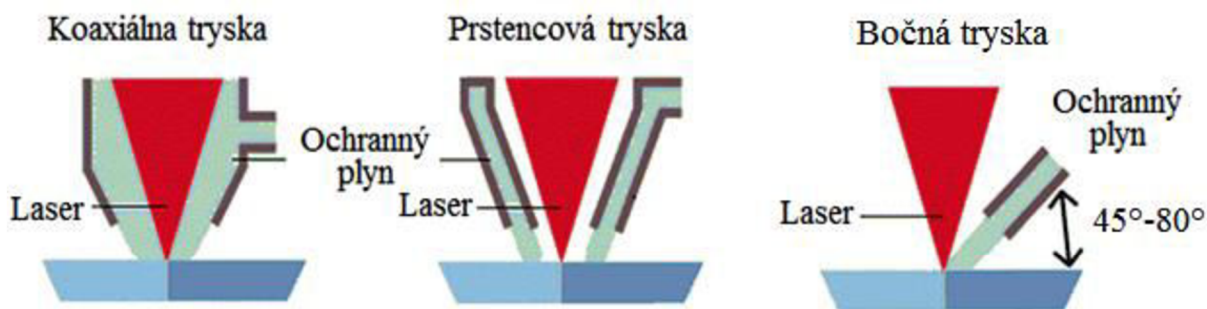
Obr. 23 Spôsoby dopravy ochranného plynu [36]
