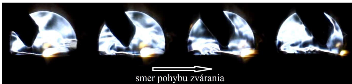
Obr. 35 Prúdenie zmesnej ochrannej atmosféry 97\text{Ar} + 3\text{CO}_2 v smere zvarovania pri rýchlosti zvarovania 5\text{mm}\cdot\text{s}^{-1}
