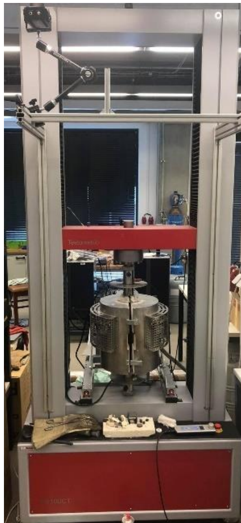
Obr. 31 Trhací stroj TESTOMETRIC FS100CT Zdroj: autor práce, 2021 (vlastní)
