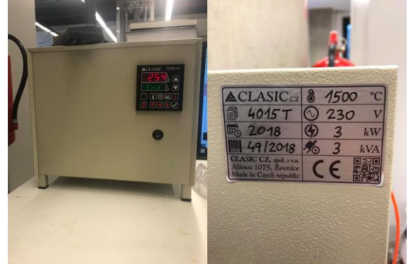
Obr. 33 Regulátor teploty a jeho štítkové údaje
